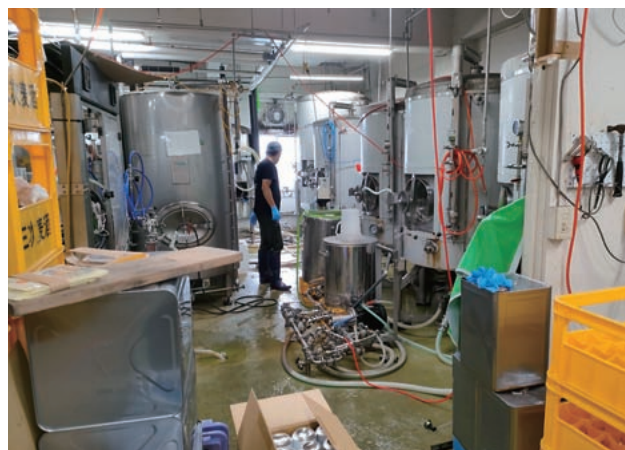
工場内には1,000ℓ～2,000ℓのタンクが30本あり、1,000ℓタンク1本で約3,000本のビールを製造しています
