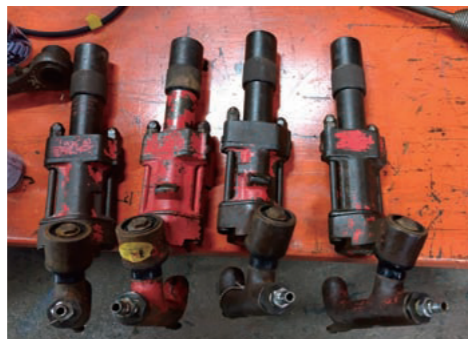
削岩機(ルートハンマー) 海底工事に必須です。海水で錆びやすくメンテナンスが欠かせません
