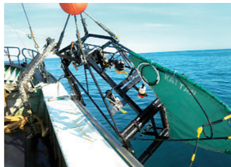
自社開発した海底撮影用装置 防水ケースに収めたスチールカメラがセットされており、接地すると自動で撮影を開始します
