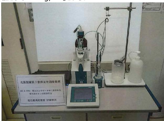
写真 2-34 塩化物イオン含有量試験状況
