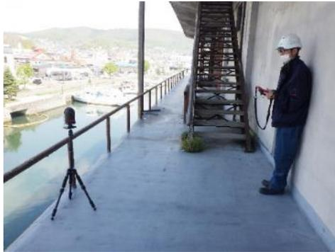
写真 2-4 3D レーザー測量状況
