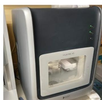
デンツプライシロナ社のセレックMC X 5で設計したCAD/CAM冠を機械で削り出します
