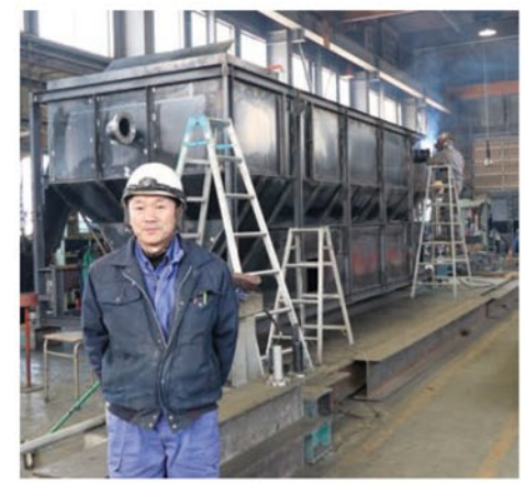
製造中の「シクナー」(汚水処理設備)
